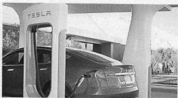
Tesla Supercharger: Mit 135 Kilowatt Leistung ist der Akku eines Tesla S Performance in 30 Minuten zu 80 Prozent gefüllt. Demnächst soll es Ladestationen geben, die das sogar in fünf bis zehn Minuten schaffen.
