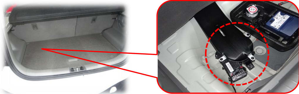
Lüfter der Hochvoltbatterie
